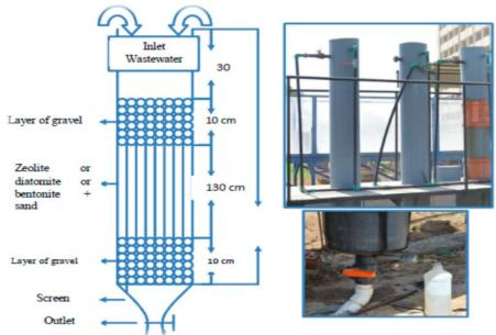
**Lab Scale Gravity Filtration Unit**
